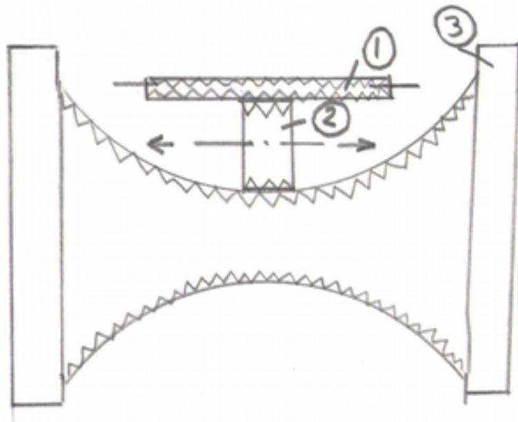
Винт ① несет за собой вращение двигателя и передает его на Боббишку ②, которая имеет подвижную ось вращения и способна двигаться влево - вправо, передавая вращение на боббишку ③, изменяя передаточное число. Концы боббишки ③ вращаются точками опоры с ПЛ-ю, т.е. колесами.
